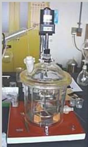
酸化窒素ガス染色堅ろう度試験装置
