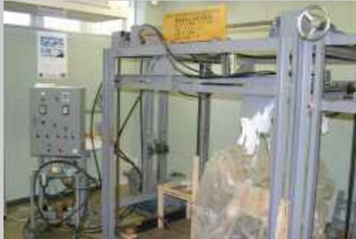
家具多能式強度試験機 さくら工業(株) AB-50 型
