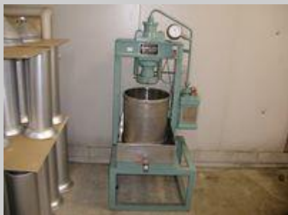
果実酒製造試験装置 池田機械工業（株） KS-1
