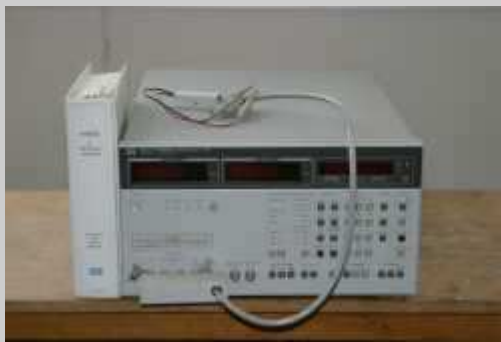
インピーダンスアナライザ 横河・ヒューレット・パッカード(株) 4192A 型
