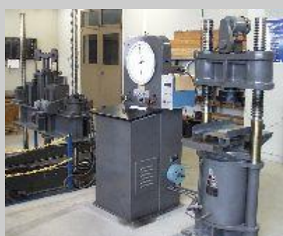
アムスラー型耐圧試験機 (20t 曲げ及び 100t 耐圧試験機) (株)前川試験機製作所 アムスラー式縦型
