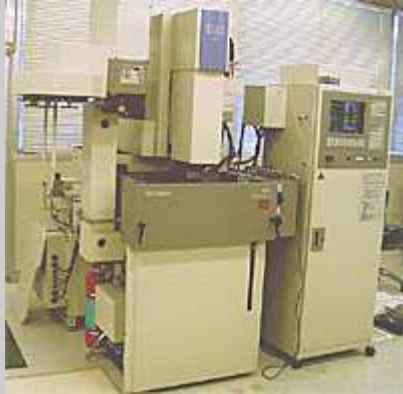
NC 形彫放電加工機 三菱電機(株) EX8+FP35E
