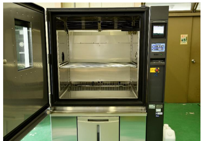
超低温恒温恒湿器 内部
